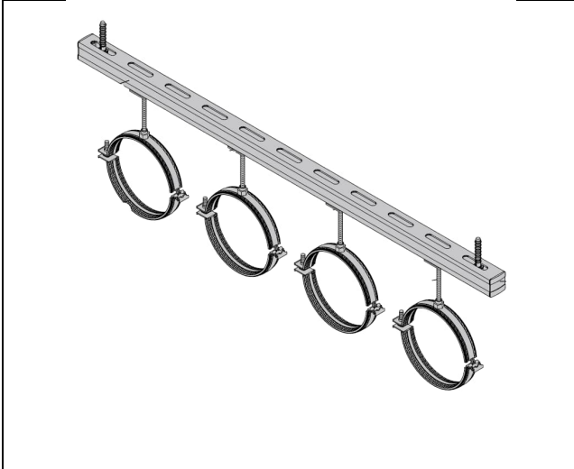
2 pav. Principinė tvirtinimo prie g/b perdangos schema
